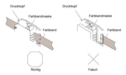
5 Zum Spannen des Farbbands den Knopf der Farbbandkassette gegen den Uhrzeigersinn drehen.
