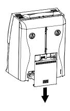
1 Abdeckung des Batteriefachs auf der Geräterückseite entnehmen, indem man die Oberseite der Abdeckung nach unten drückt und dann aus den zwei Klammern aushängt.
