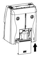
4 Abdeckung wie links gezeigt in die Nut einführen. Solange nach unten drücken, bis sie in die Klammer einrastet.
