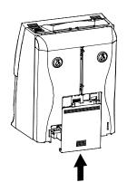
5 Den Deckel des Anschlussfaches gemäss Skizze wieder aufsetzen und sicherstellen, dass das Anschlusskabel nicht eingeklemmt ist.
